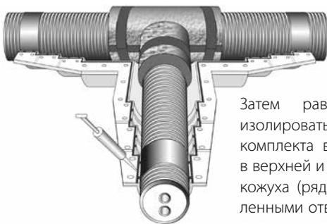
Затем равномерно заизолировать изоляцией из комплекта вдоль фланцев в верхней и нижней частях кожуха (рядом с просверленными отверстиями) для получения толщины около 6 мм.
